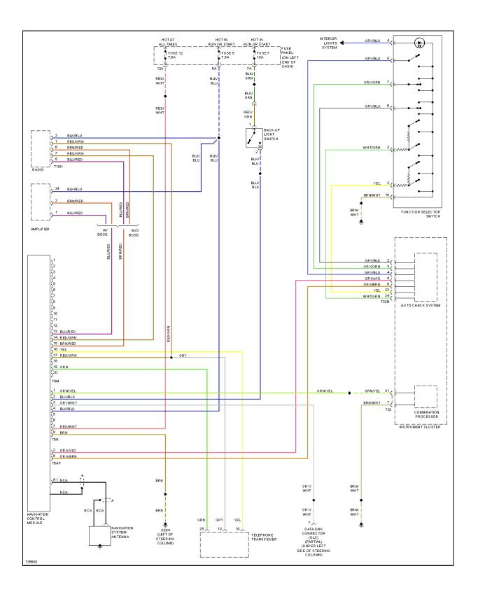
Fig. 33: Navigation Circuit
