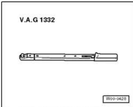
**Fig. 140: Torque Wrench V.A.G. 1332**
