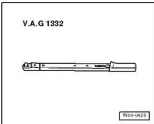
**Fig. 137: Torque Wrench V.A.G. 1332**
