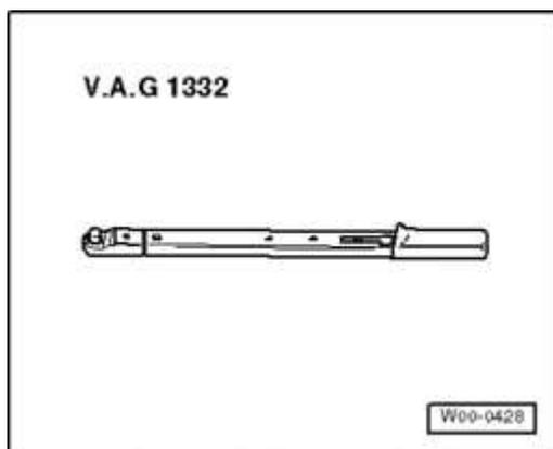
**Fig. 157: Torque Wrench V.A.G. 1332**
